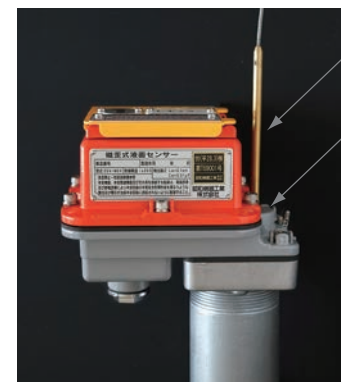
専用検水口からのワイヤー式検水棒による測定
