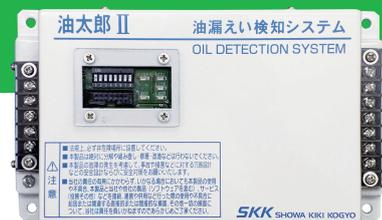
簡易型警報装置 ODS-C IISB (センサー1基用)
