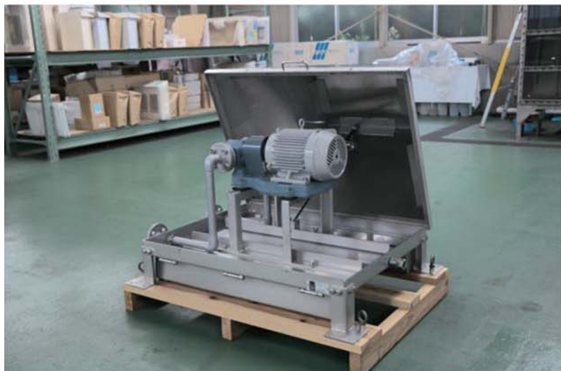
モーターやポンプの水没を防ぐ「ポンプエアシェルター」
