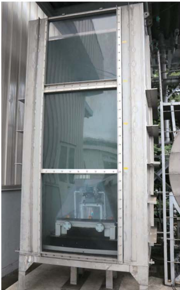
冠水した状態でも内部の水位上昇を抑える（水深3層の水槽に設置しての水没試験）
