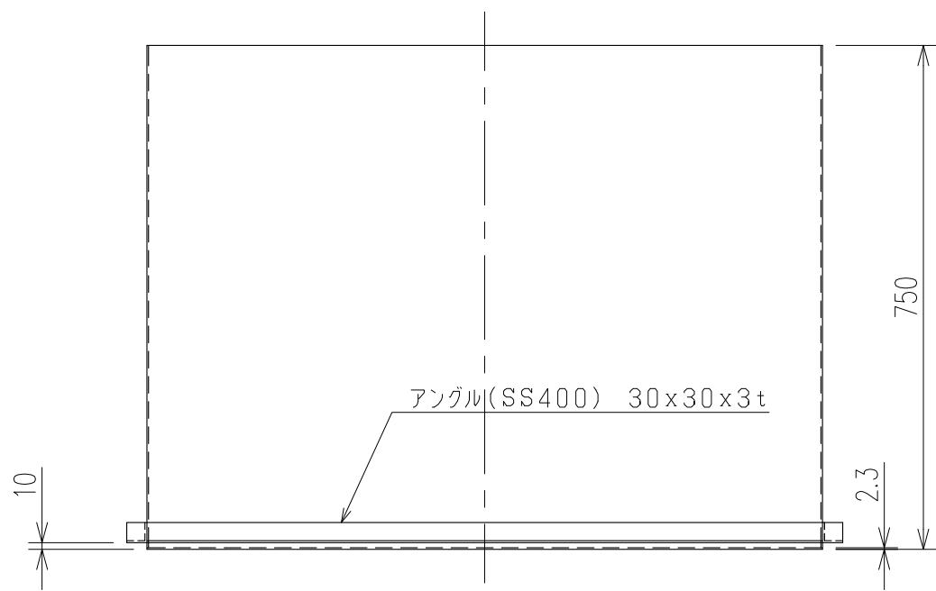
材質: SPHC  $t = 2.3\text{mm}$
